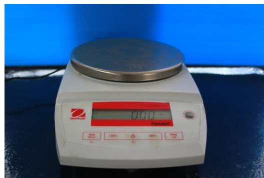
รูปที่ 3.2 เครื่องชั่งน้ำหนักไฟฟ้าอ่านได้ละเอียด 0.01 กรัม
