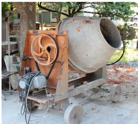
รูปที่ 3.7 เครื่องผสมคอนกรีต
